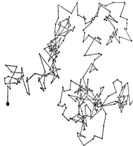
Броуновское движение частички гуммигута в воде. Мелкими точками отмечены положения частички через каждые 30 сек. (По Перрену.)
